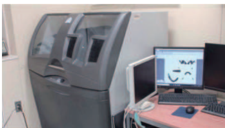
図5 石膏3Dプリンター ProJet 460plus (3D Systems)
