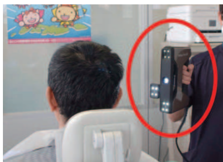
図 1 ハンデイスキャナー (EinScan Pro HD, Shining3D)
