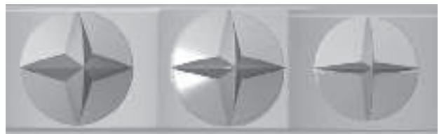
図 切削試験に用いた試験片形状 左より面間角度 40, 30, 15 度
