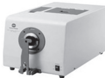
図 分光測色計 KONICA MINOLTA 製 CM-3600d
