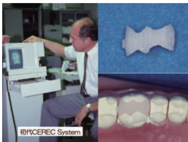
図1 初代 CEREC System によるセラミックインレーの製作
