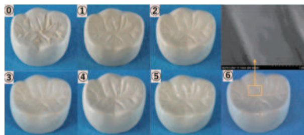
図4 各研磨工程後の咬合面および最終工程後のSEM画像 (倍率50倍)
