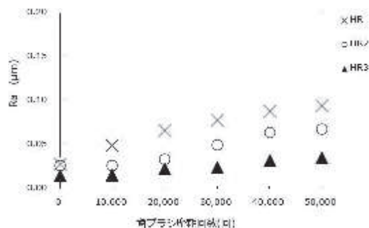
図 1 歯ブラシ摩耗試験による表面粗さの変化
